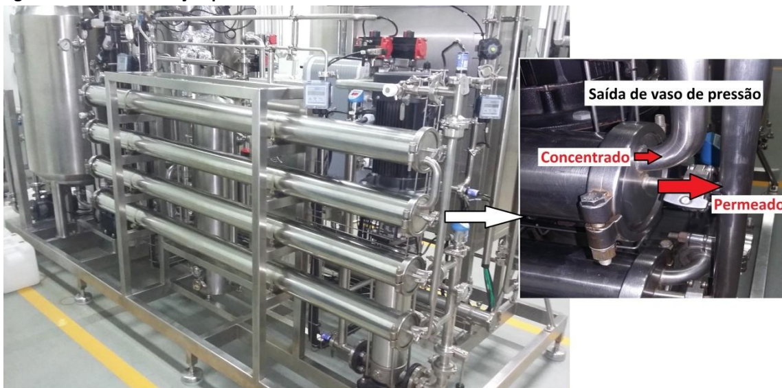
Figura: Sistema de filtração por osmose reversa
